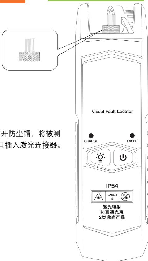
打开防尘帽，将被测光纤接口插入激光连接器。
